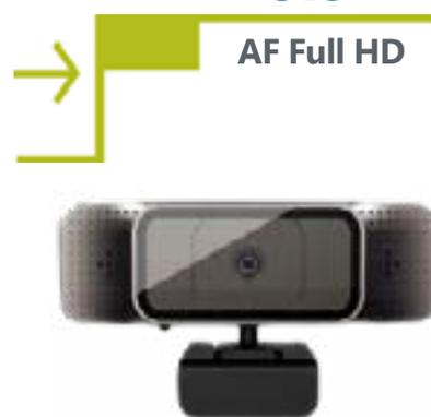
Caméra AF Full HD 1080p 25 ips, avec prise trépied. Champ de vision 70°. Résolution optique de 2 MP. Micro omnidirectionnel intégré
