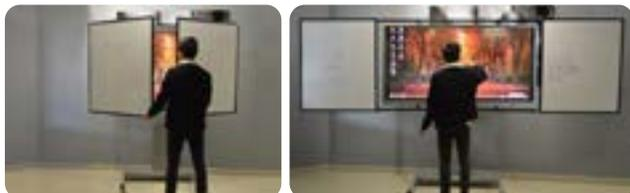
Ce cadre se fixe sur support mobile ou fixe (en option) selon les besoin et permet d'intégrer un écran interactif capacitif ou infrarouge (en option) au centre de la solution à travers un support de fixation VESA
