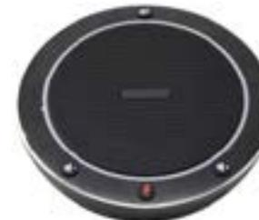
Pour des salles de 40-60 m<sup>2</sup>. Rayon de prise de voix : 3 m (de 6 à 8 participants). Volume de HP max 90 db. Fréquence micro et HP :100hz-7khz
