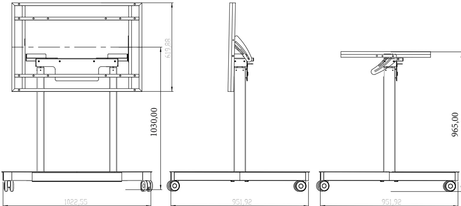
Configuration du chariot / support de roue : 1265mm
